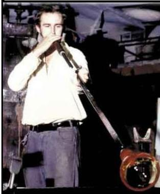
50 avant JC Découverte du soufflage. Une masse de verre est prélevée dans le creuset de fusion au bout d'un tube puis on souffle dans le tube pour fabriquer des objets creux
